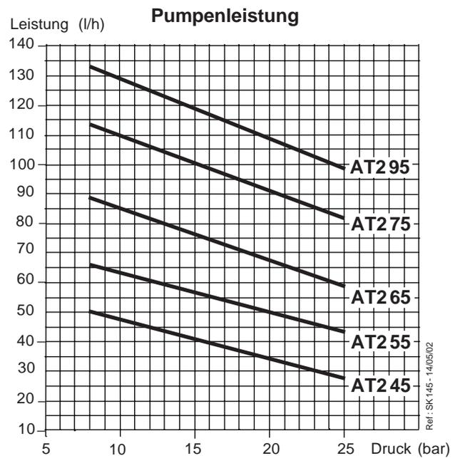
Viskosität = 5 cSt - Pumpendrehzahl = 2850 U/min
